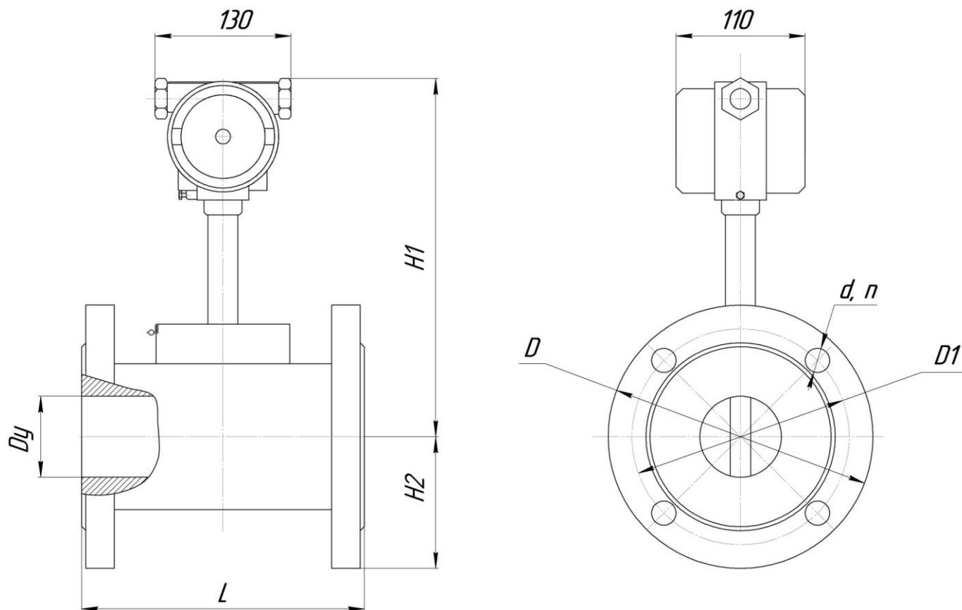
Рисунок В.1 - Преобразователь расхода Тирэс (исполнение А) температурного исполнения Т1.
