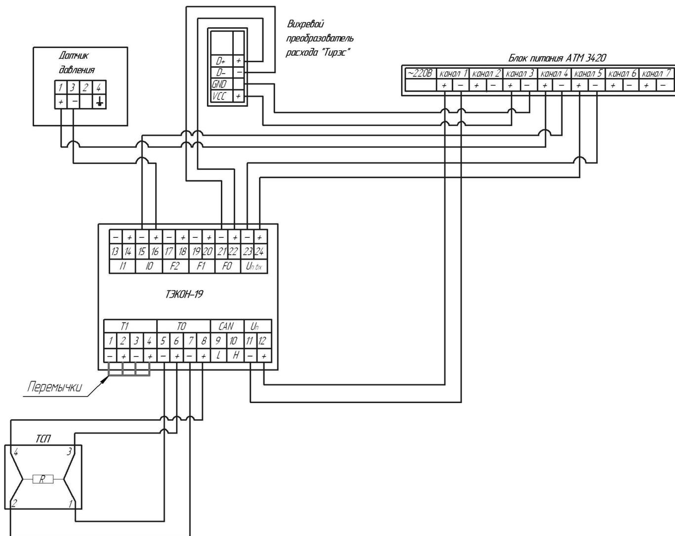
Рис.Д9 Схема подключения преобразователя расхода при использовании в комплексе учета энергоносителей ТИРЭС-Т (применен контроллер Тэкон 19)
