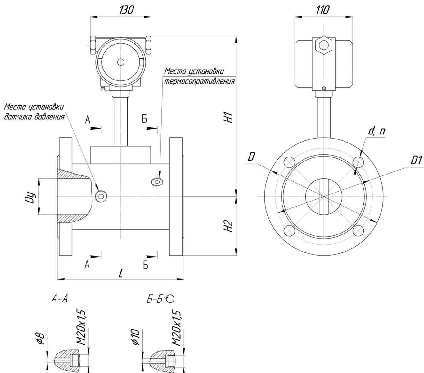
Рисунок В.8 - Преобразователь расхода Тирэс (исполнение F) температурного исполнения Т1.
