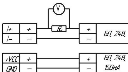
(б) Подключение преобразователя расхода на клеммной колодке электронного блока;
