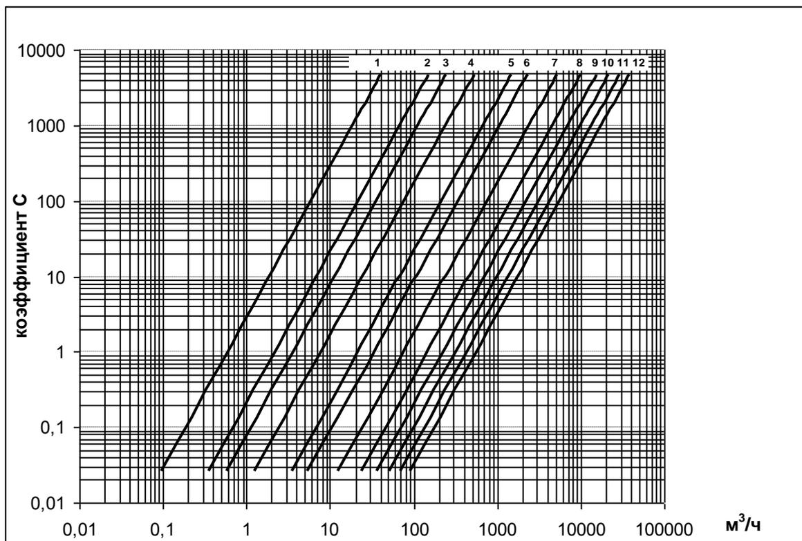
Гидродинамические потери давления зависят от типоразмера преобразователя расхода и плотности измеряемой среды. Формула расчета:  $\Delta P(\text{Па}) = \text{коэффициент } C * \rho$ ,
