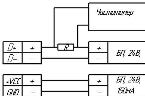
(б) Подключение преобразователя расхода на клеммной колодке электронного блока;
