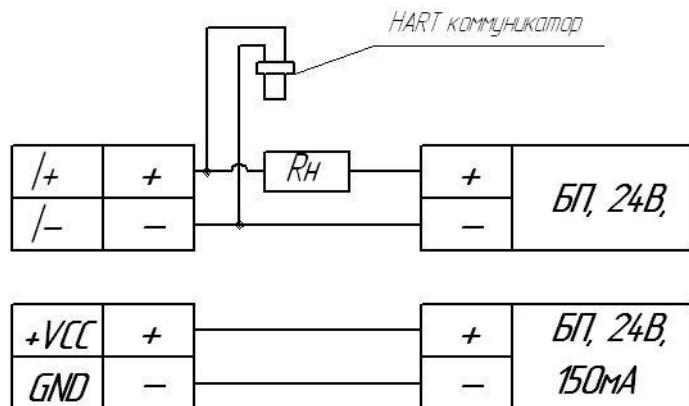
Рис.Д4 Схема подключения преобразователя расхода при работе с цифровым выходным сигналом HART (подключение HART коммуникатора)
