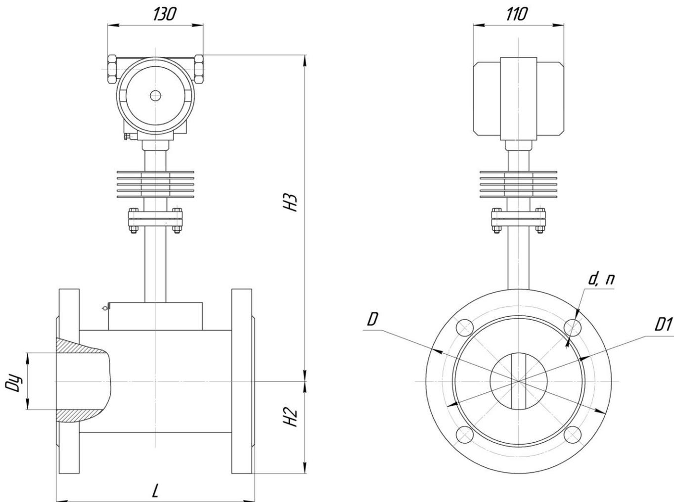
Рисунок В.2 - Преобразователь расхода Тирэс (исполнение А) температурного исполнения Т2.
