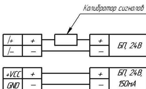
(б) Подключение преобразователя расхода на клеммной колодке электронного блока;
