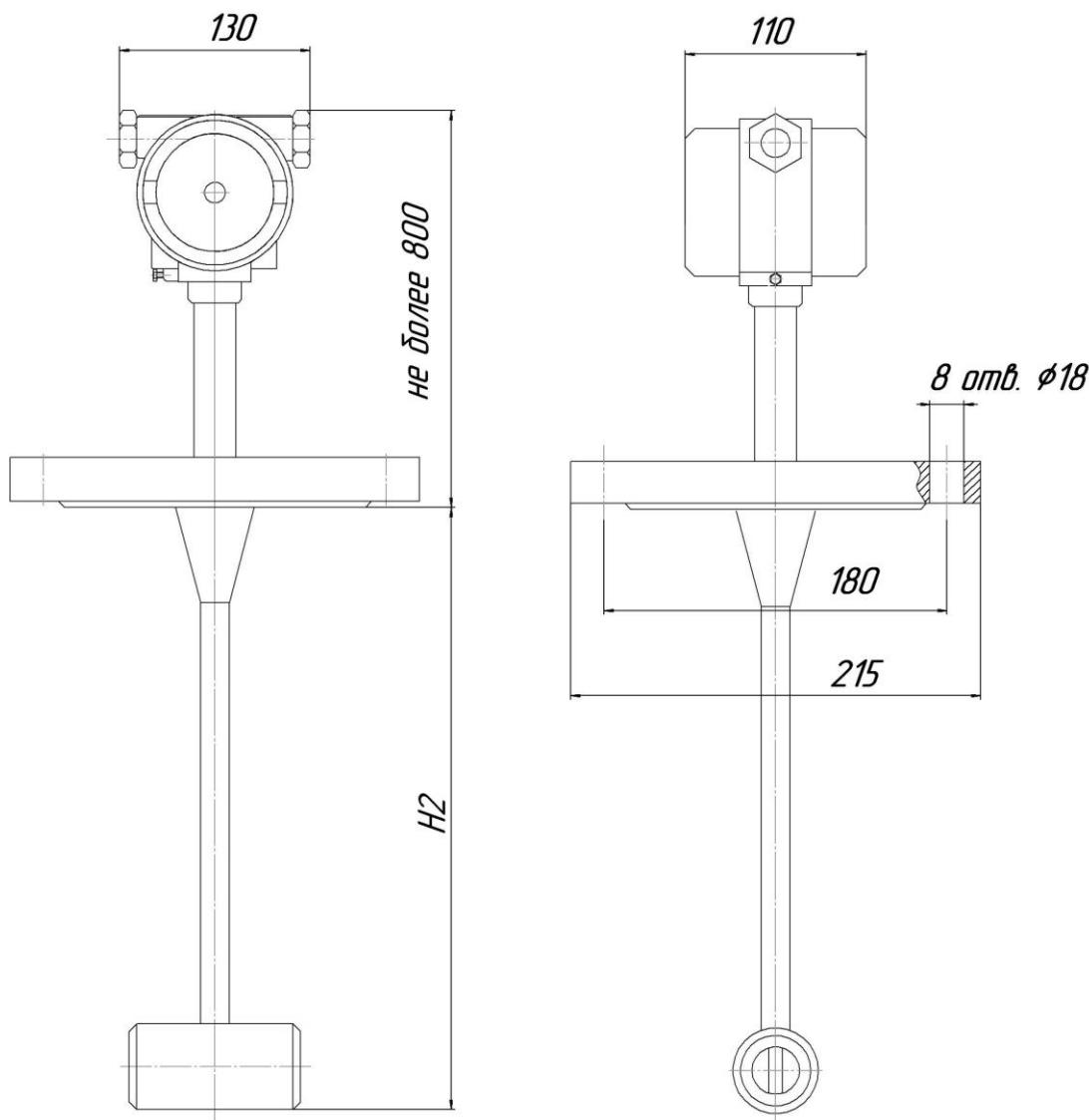
Рисунок В.4 - Преобразователь расхода Тирэс (исполнение С1) температурного исполнения Т1, Т2.
