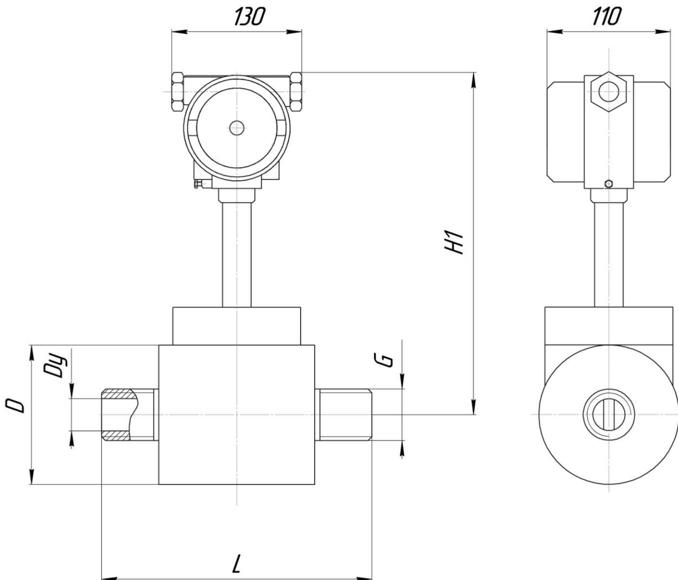
Рисунок В.7 - Преобразователь расхода Тирэс (исполнение D) температурного исполнения Т1.
