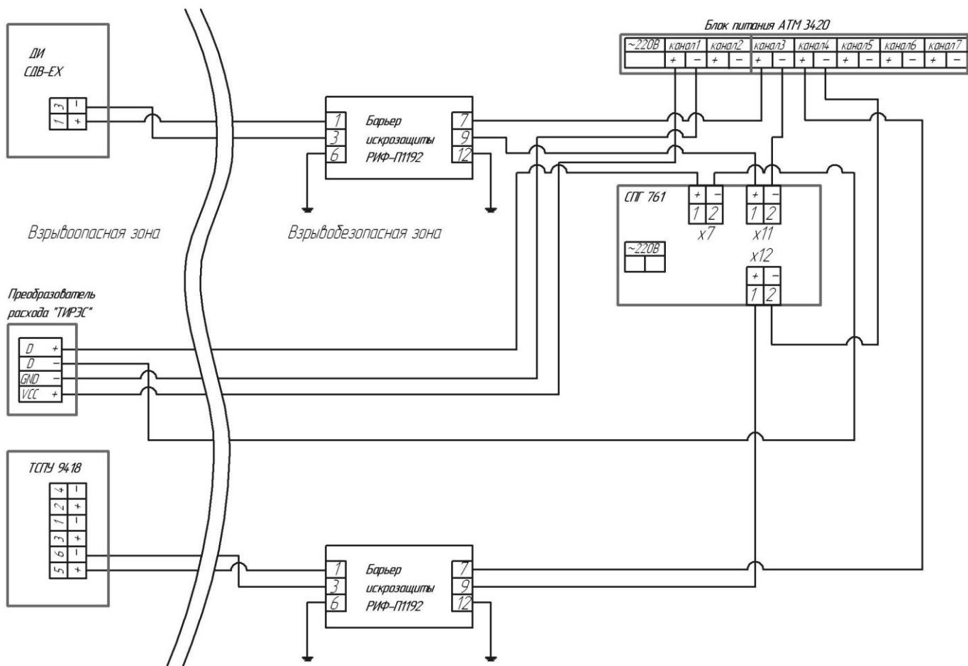
Рис.Д11 Схема подключения преобразователя расхода при использовании в комплексе учета энергоносителей ТИРЭС-Т (применен контроллер СПГ761)
