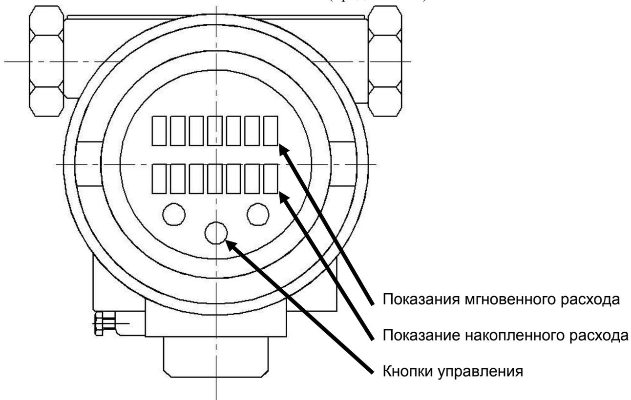
Рисунок В.12 – Электронный блок с ЖКИ
