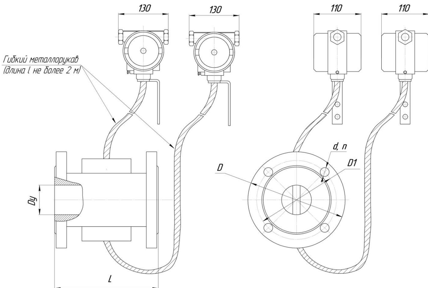
Рисунок В.11 - Сдвоенный преобразователь расхода Тирэс (исполнение I) с резервным блоком электроники и измерительным сенсором (использование в системах, где важна функция резервирования).
