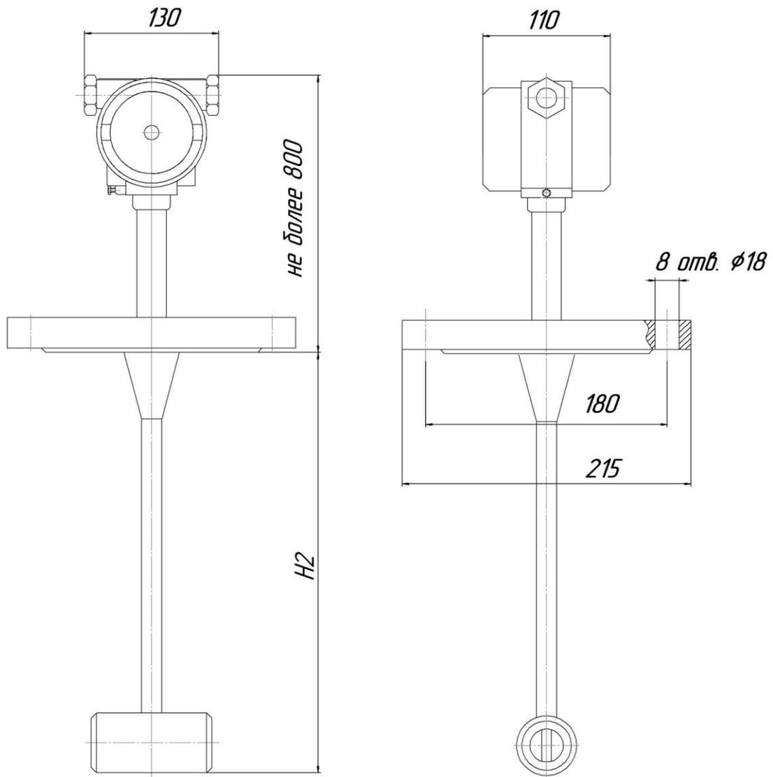
Рисунок В.4 - Преобразователь расхода Тирэс (исполнение С1) температурного исполнения Т1, Т2.
