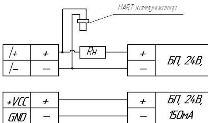
Рис.Д4 Схема подключения преобразователя расхода при работе с цифровым выходным сигналом HART (подключение HART коммуникатора)
