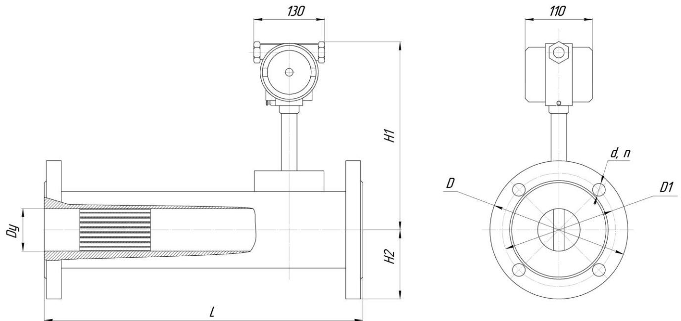
Рисунок В.1 0- Преобразователь расхода Тирэс (исполнение Н) со встроенным струевыпрямителем.
