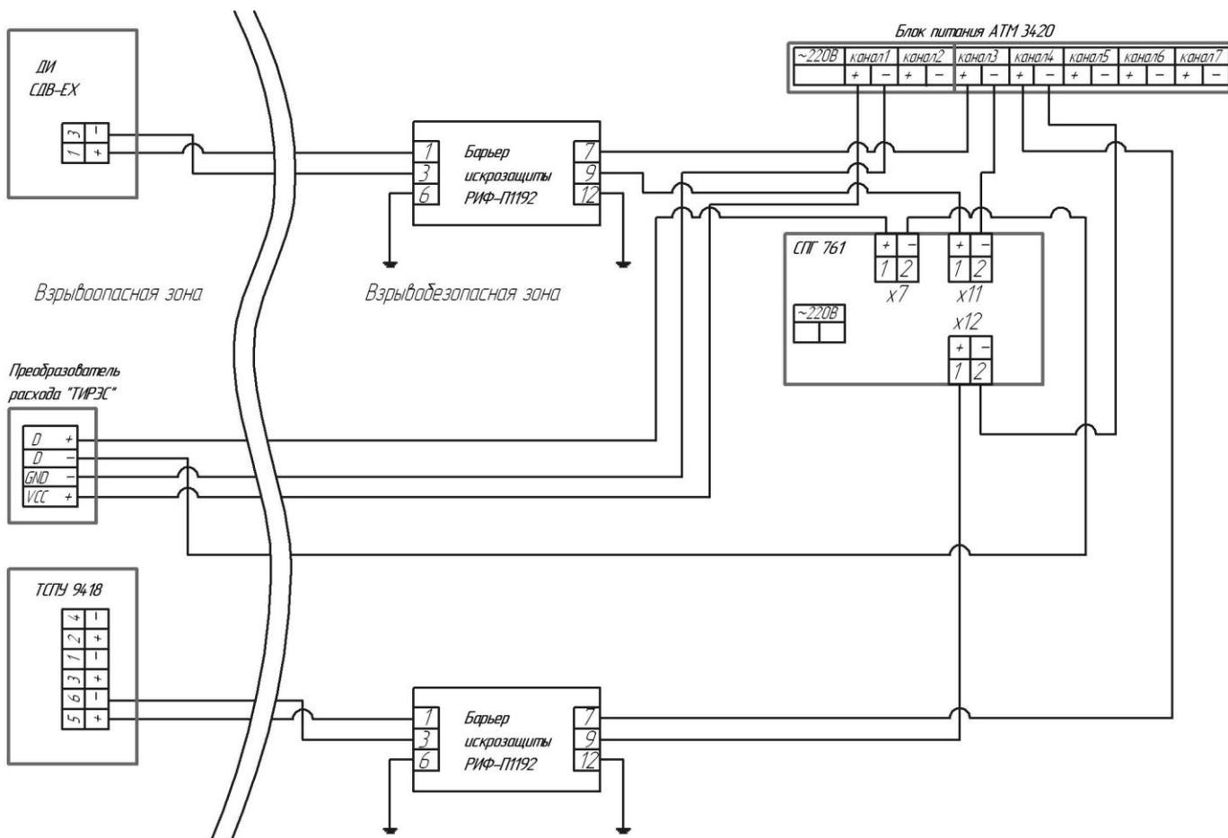
Рис.Д11 Схема подключения преобразователя расхода при использовании в комплексе учета энергоносителей ТИРЭС-Т (применен контроллер СПГ761)
