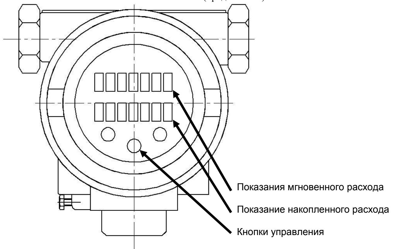
Рисунок В.12 – Электронный блок с ЖКИ
