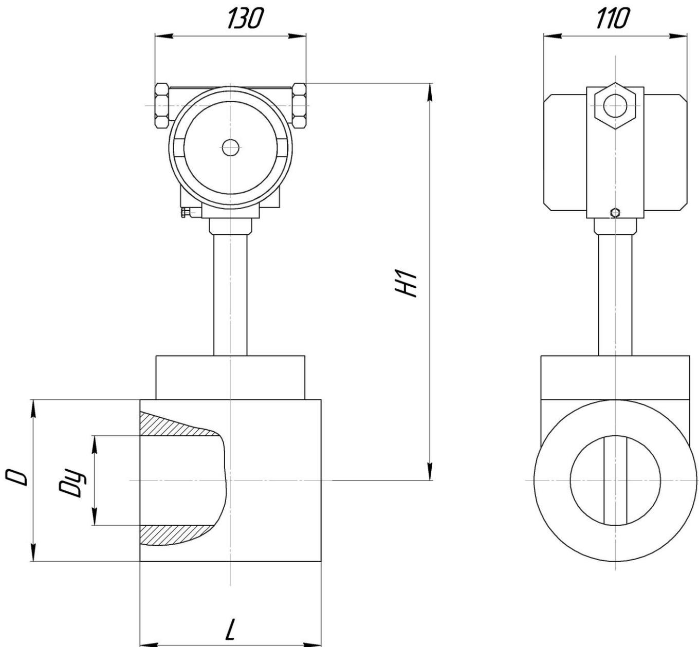
Рисунок В.6 - Преобразователь расхода Тирэс (исполнение В) температурного исполнения Т1.
