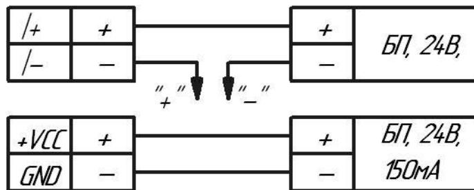
Рис.Д2 Схема подключения преобразователя расхода при работе с токовым выходным сигналом 4-20mA
