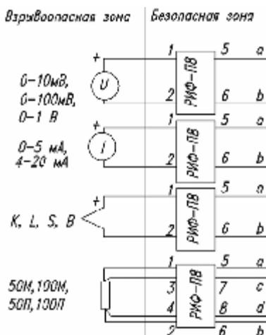
Рисунок 2.1 – Подключение к устройству датчиков, расположенных во взрывоопасной зоне (остальное – см. приложение Б)
