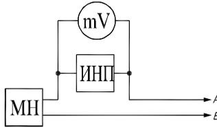
Рисунок Б.9 - Схема проверки влияния помехи
